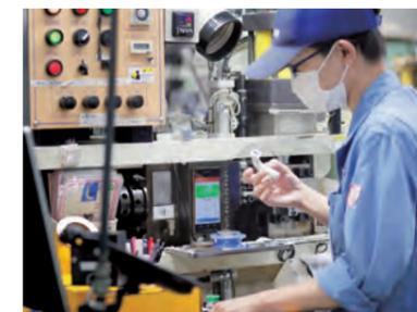
1人の技術者を取り囲むように工作機械を配置し、全行程を任せるのが「一個流し生産」だ
