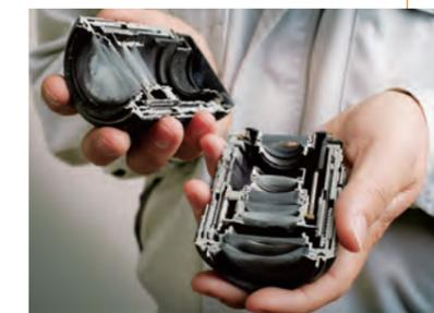
加工するモノに対する負担が小さいため、製品の内部を調べる検査にもよく使われる
